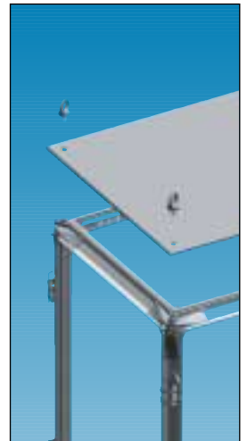
Угловой элемент обеспечивает удобную установку верхней панели. В него вворачиваются крепежные винты или рым-болты для транспортировки
